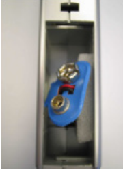
Fig.4. PP3 battery connector
